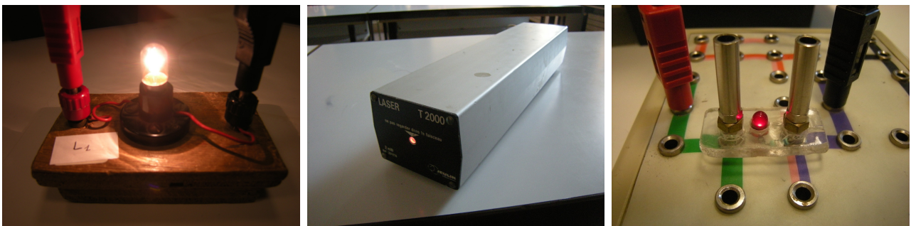
FIGURE 3 – Trois sources primaires artificielles de lumière : ampoule (lampe à incandescence), laser (light amplification by stimulated emission of radiation ou amplification de lumière par émission stimulée de radiations), LED (light emitting diode ou diode électroluminescente)
